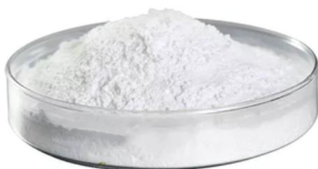
Стеарат кальция 304-MCS применяется как внутренняя смазка и термостабилизатор в производстве полимеров.
